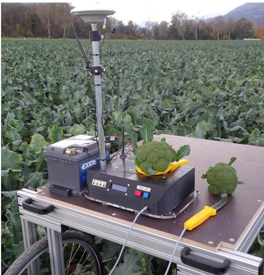
Abbildung 16: Prototyp des Erntemoduls im Feldversuch 1
