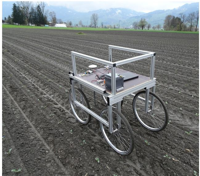
Abbildung 9: Wagen zur Positionsvermessung mittels DGPS
